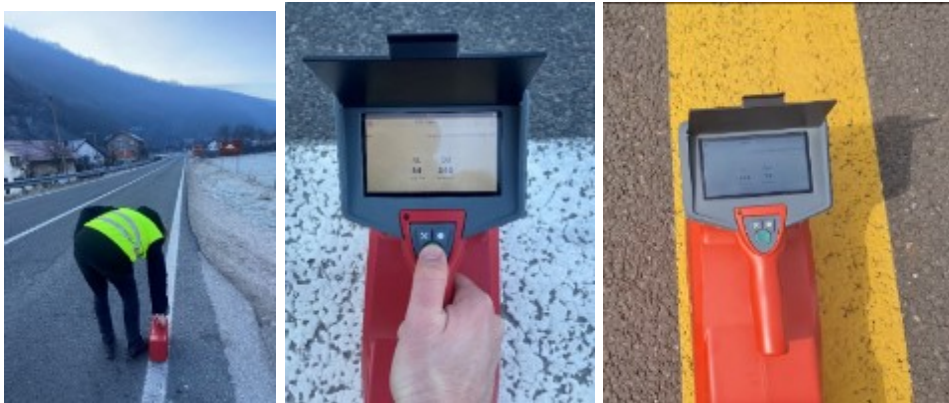
Slika 2: Mjerenje retrorefleksije horizontalne signalizacije RETROSIGN LTL3000
