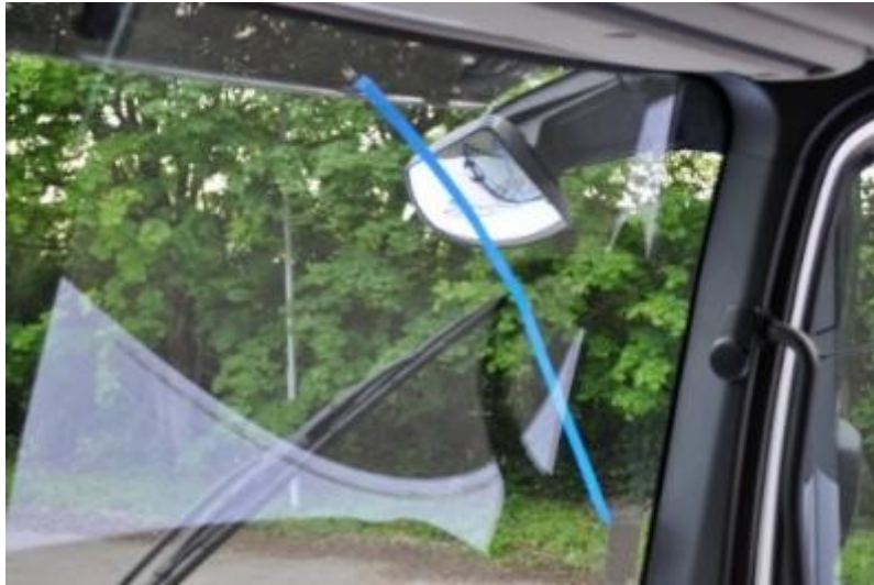
Slika 9. Deo stakla vetrobrana koji nije pokriven radom brisača stakla
