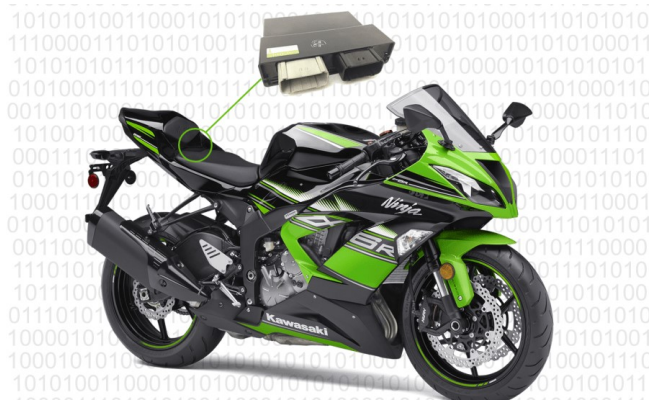
Slika br. 3 Pozicija EDR-a na motociklu
