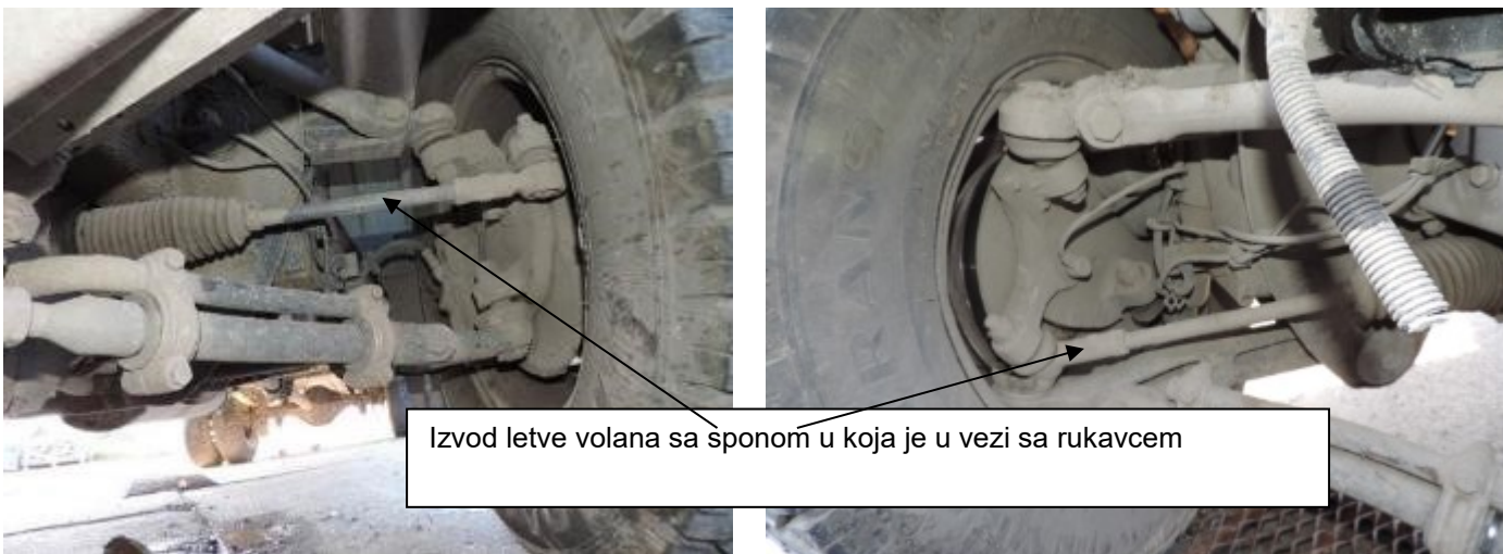
Ft.6 Stanje upravljačkih i veza vešanja na točku prednjem levom
