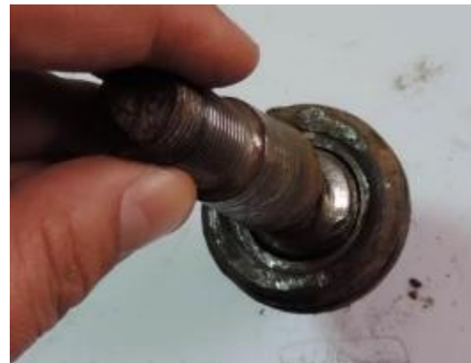
Ft.14 Spoj kugle i šolje je pod određenim uglom razdvojiv rukom
