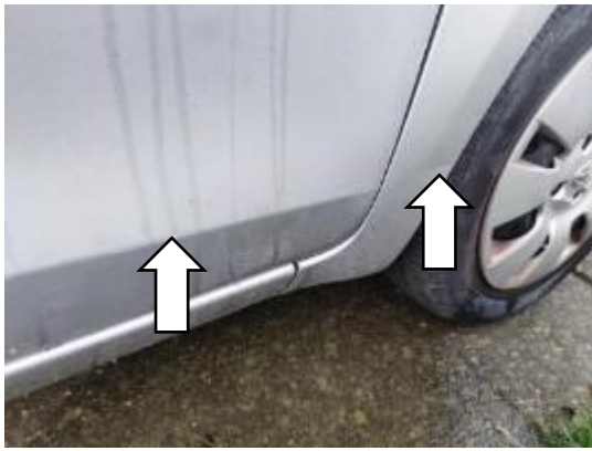
Sl. 18. Označena linijska oštećenja
