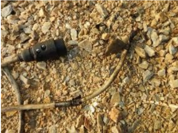
Ft.5 Utikač i mesto prekida provodnika
