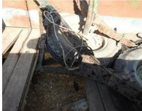
Ft.4 Ostaci prednje osovine i rude sa delom električnog provodnika
