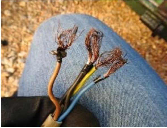
Ft.7 Provodnici na prekinutom prednjem kraju
