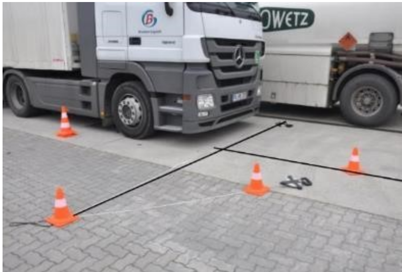
Slika 10. Postupak utvrđivanja linije vidljivosti iz kabine teretnog vozila
