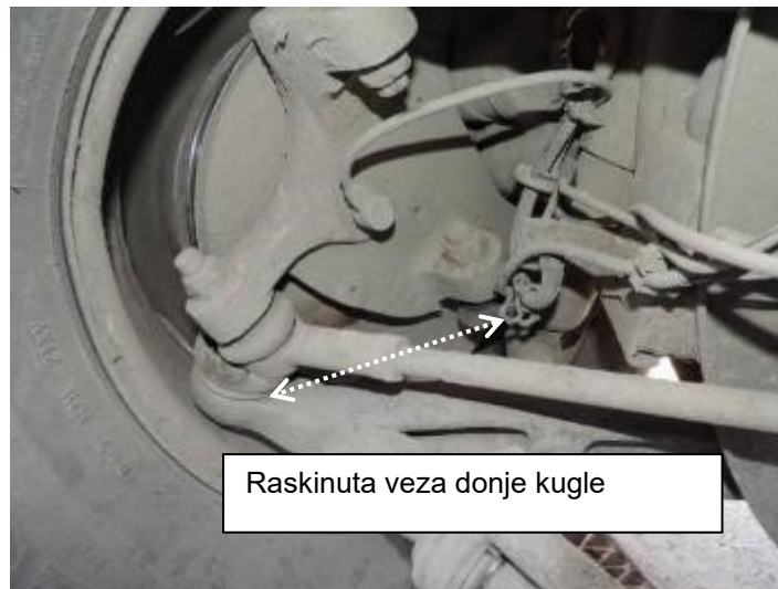
Ft.8 Zatečeno stanje vešanja na točku prednjem desnom (rukavac zarotiran)
