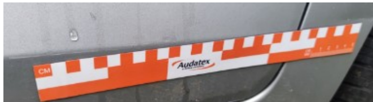
Sl. 20. Poređenje linijskih oštećenja lenjirom (bliži izgled)
