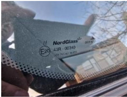
Sl. 23. Prikaz kataložnog broja stakla
