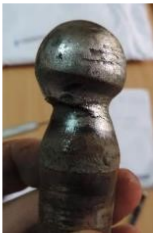
Ft.13 Plastična deformacija kugle
