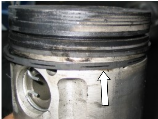
Slika 6. Pohabanost radnih površina uljnog klipnog prstena kao posledica nesagorelog goriva
