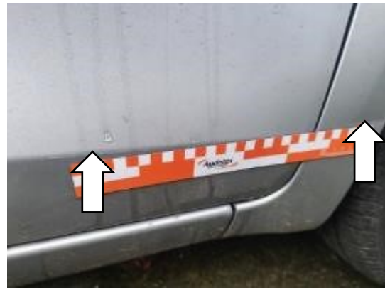
Sl. 19. Poređenje linijskih oštećenja
