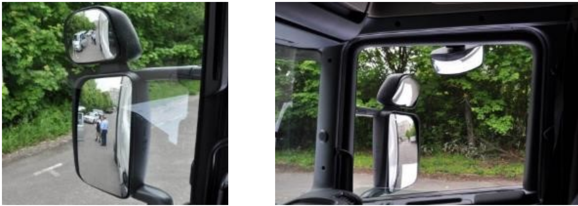
Slika 13, 14. Uticaj položaja stubova i ogledala na vozilu na direktnu vidljivost
