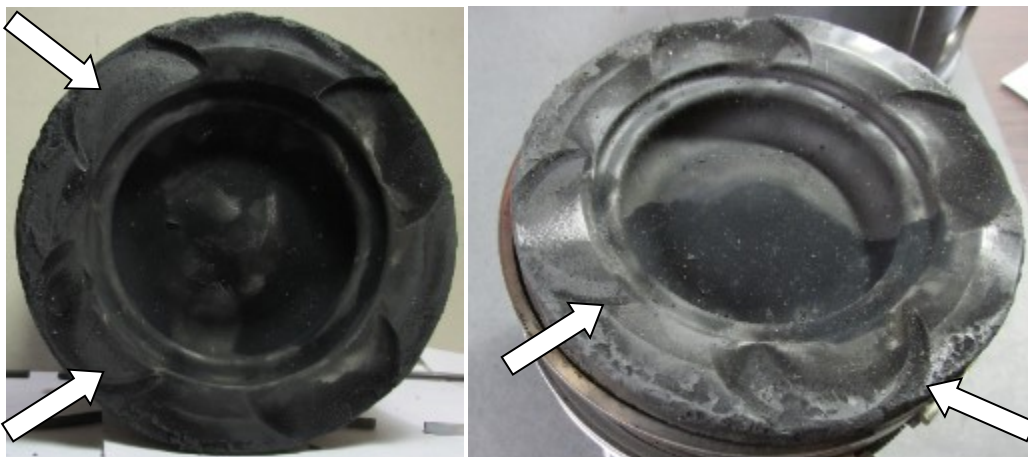
Slika 4. Primer kontakta ventila i klipova koji su rezultirali i povišenom potrošnjom ulja
