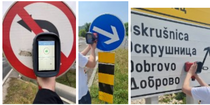
Slika 1: Mjerenje retrorefleksije uređajem DELTA RetroSign GRX
