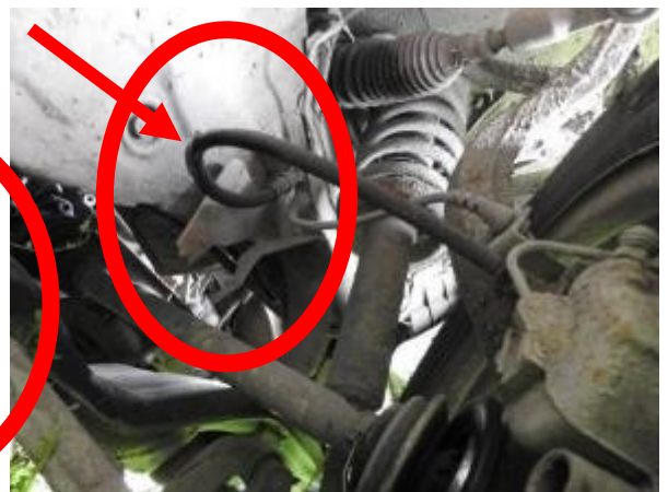
Ft.7 Kočiona instalacija točka prednjeg desnog
