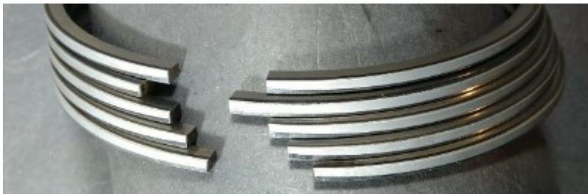
Slika 5. Klipni prstenovi sa nedovoljno uhodanim radnim površinama
