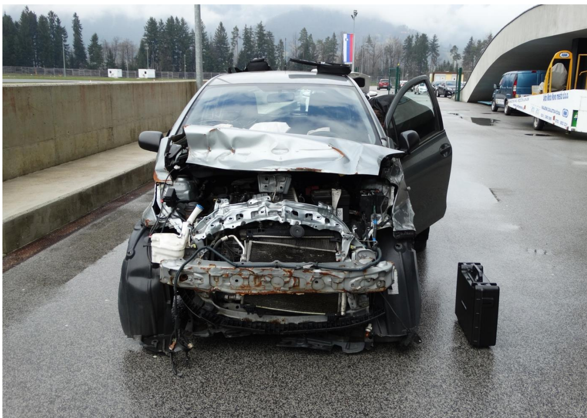
Slika 3: Oštećenja čeonog dela vozila Toyota Yaris
