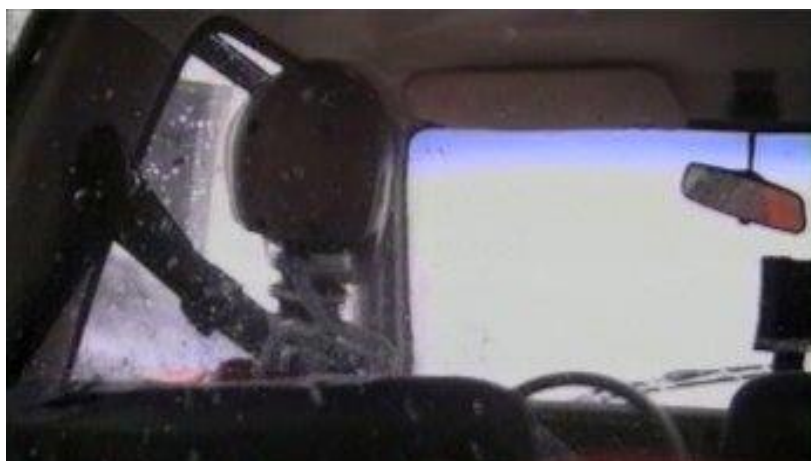
Slika 16 – Prikaz kretanja glave lutke prema vertikalnom nosaču krova karoserije vozila [3]
