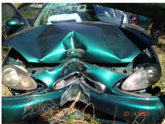
Sable iz 1996, sudarna brzina 69 km/h, maksimalna deformacija 0,37 m [10] Sable iz 1996, sudarna brzina 75 km/h, maksimalna deformacija 0,50 m [10]
