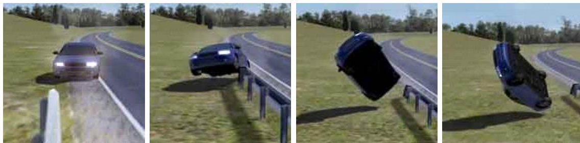
Slika 3. Prevratanje vozila pri naletanju na odbojnu ogradu
