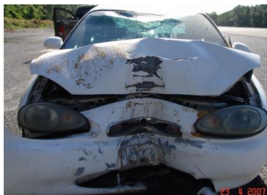
Sable iz 1996, sudarna brzina 69 km/h, maksimalna deformacija 0,37 m [10] Sable iz 1996, sudarna brzina 75 km/h, maksimalna deformacija 0,50 m [10]
