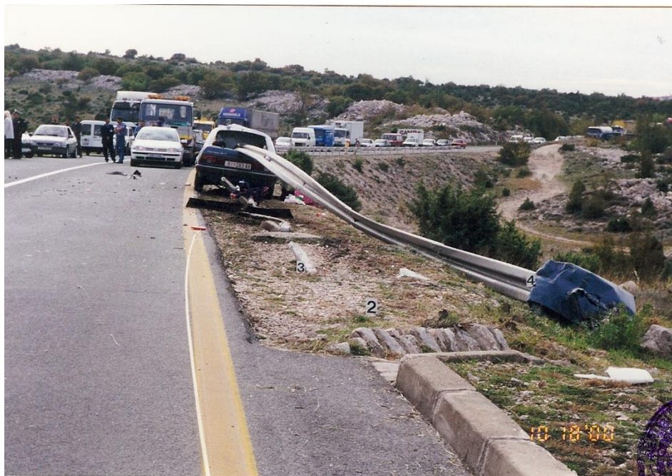
Slika 13 – Prikazuje nalet vozila na željeznu ogradu i posljedice naleta
