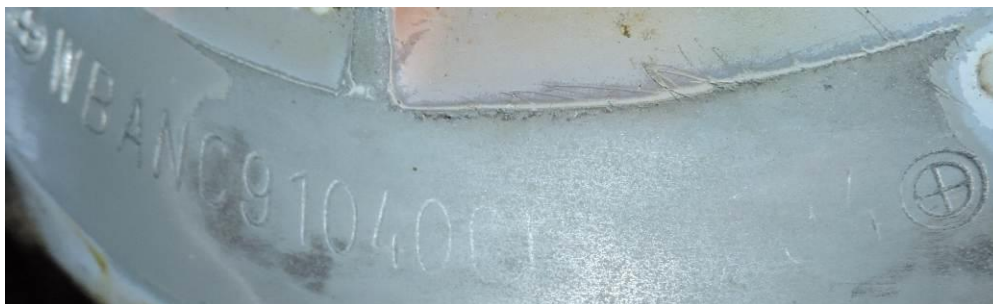
Sl. 8 Očitani VIN broj postavljen u jednom redu
