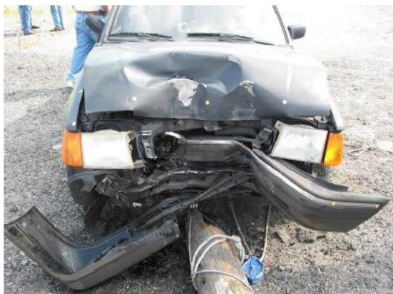
Ford Escord iz 1989, sudarna brzina 47 km/h, maksimalna deformacija 0,43 m [10] Ford Taurus iz 1999, sudarna brzina 78 km/h, maksimalna deformacija 0,39 m [10]
