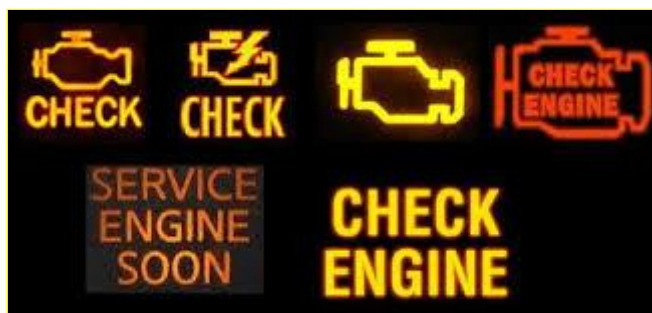
Slika 1. - Kontrolna sijalica MIL
