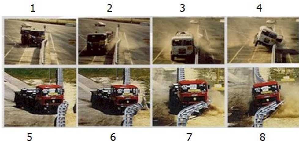
Slika 2 – Glavne faze dinamike zadržavanja vozila kod ograde "3n" [2]
