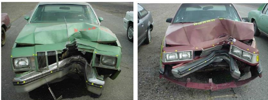
Oldsmobile Cutlass iz 1978, sudarna brzina 45 km/h, maksimalna deformacija 0,64 m [10] Chevrolet Celebrity iz 1986, sudarna brzina 49 km/h, maksimalna deformacija 0,55 m [10]
