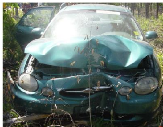
Ford Escord iz 1989, sudarna brzina 47 km/h, maksimalna deformacija 0,43 m [10] Ford Taurus iz 1999, sudarna brzina 78 km/h, maksimalna deformacija 0,39 m [10]
