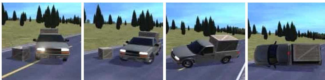
Slika 4. Prevratanje vozila sa visokim težištem prilikom izbegavanja naleta na prepreku
