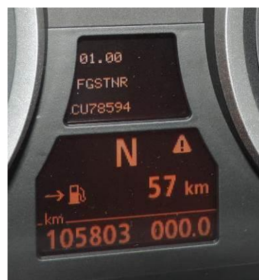
Sl. 10 Broj šasije na bord kompjuteru
