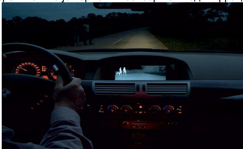
Слика 3. BMW Night Vision систем са термалном камером [4]
