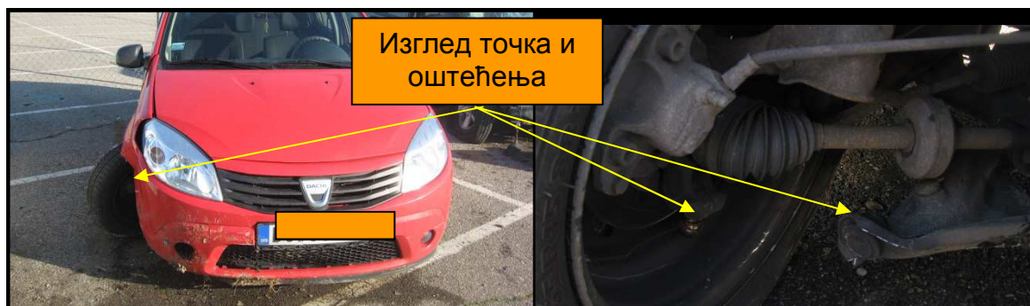
Слика 3. Приказ управљачког механизма и неисправност (испадање кугле из лежишта) као узрок саобраћајне незгоде
